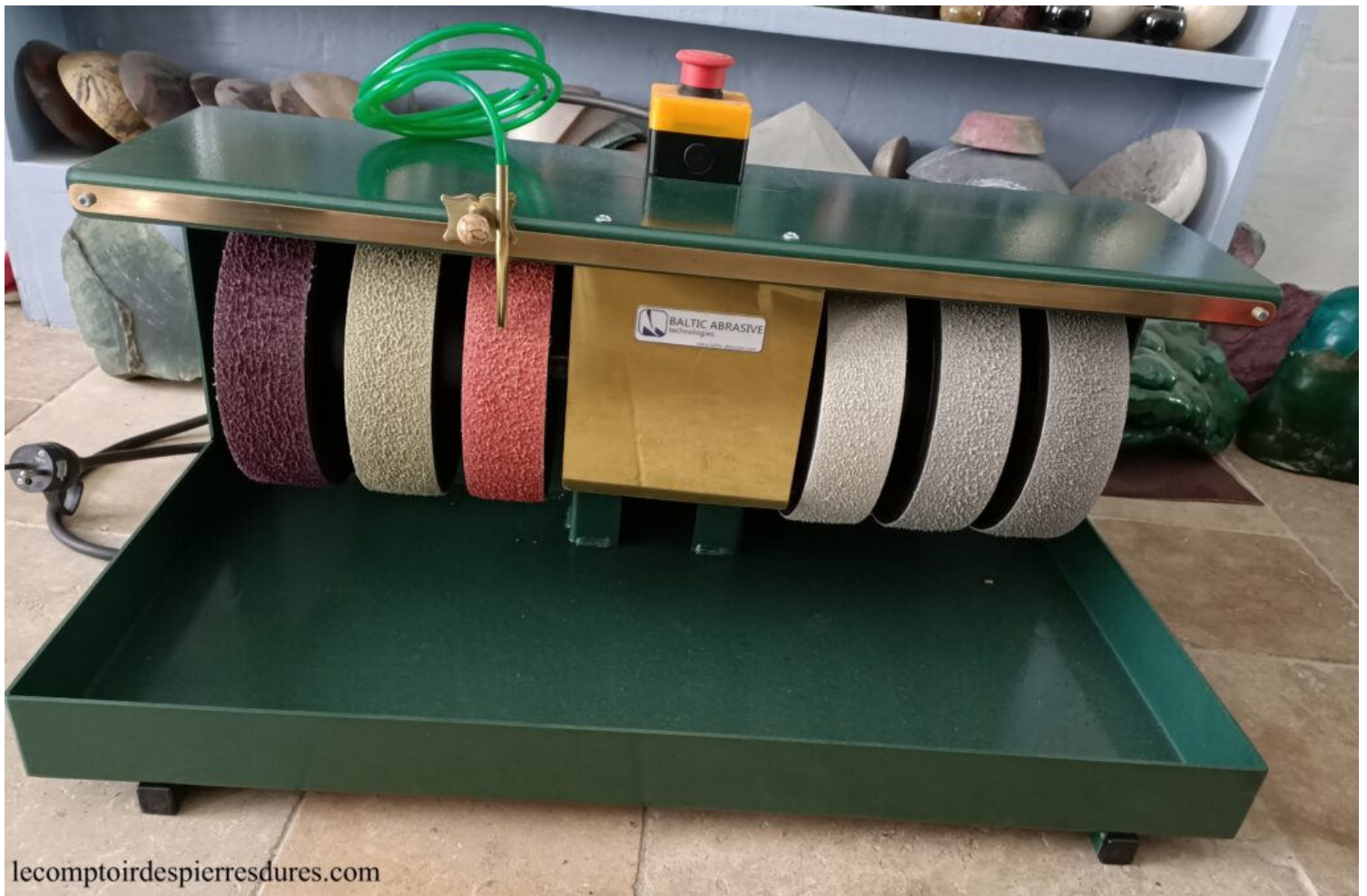
Photo d'une cabochonneuse montée avec 6 meules
